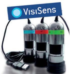
VisiSens vereint **chemisch-optische Sensor-Folien mit Imaging Technologie** und ermöglicht so die einfache 2D-Visualisierung von Sauerstoff-, pH- und Kohlenstoffdioxid-Verteilungen. Die Sensorfolie wird auf der Oberfläche Ihrer Probe angebracht und übersetzt den Gehalt des entsprechenden Analyten in ein Lichtsignal. Die Sensorantwort wird Pixel für Pixel mit der handlichen Detektoreinheit aufgezeichnet. So nehmen Sie sowohl räumliche als auch zeitliche Veränderungen auf.
