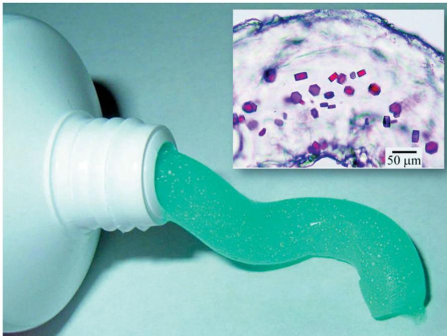
Die Lipidic Cubic Phase, die für die *In-meso*-Kristallisation von Proteinen genutzt wird, hat eine ähnliche Konsistenz wie Zahnpasta. Im Insert sind kleine Proteinkristalle zu erkennen, die in der Lipidic Cubic Phase wachsen.
