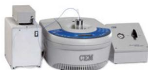
**Vorteile:** Ein klassisches Beispiel ist der Transferrin-Verdau. Der konventionelle Verdau dauert je nach Qualität des schneidenden Enzyms bis zu 16 Stunden. Der Verdau mit Mikrowellen-Unterstützung dauert demgegenüber nur zehn Minuten. Zudem sind in der Mikrowelle Schnitte realisierbar, die konventionell praktisch gar nicht stattfinden.
