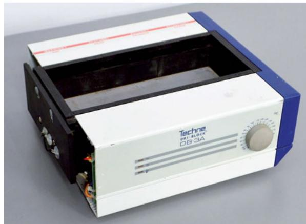
*Die guten alten analogen Blockthermostate findet man mittlerweile fast nur noch auf Ebay oder bei den einschlägigen Händlern für gebrauchte Laborgeräte. Nur noch wenige Hersteller bieten Neugeräte als preiswerte Alternative zu digitalen Blockthermostaten an.*
