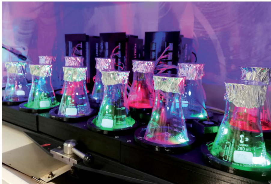
Geschüttelt, nicht gerührt: Suspendierte Pflanzenzellen bekommen eine individuelle Lichttherapie im LEDitSHAKE-Beleuchtungssystem, ...
