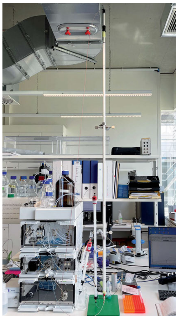
Kevin Pagels Team schreckt bei der Analyse von Zuckern vor nichts zurück – auch nicht vor dem Packen einer zwei Meter langen Größenausschluss-Säule, die so zerbrechlich aussieht wie eine Neonröhre.
